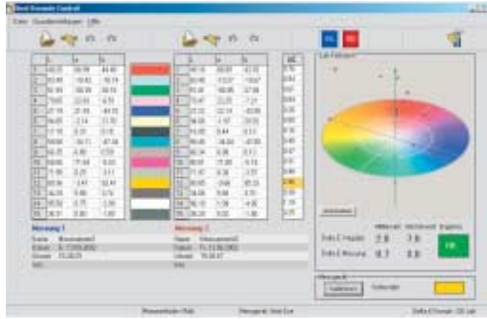
Die Messwerte von Versender und Empfänger werden verglichen. Bleibt die Abweichung innerhalb des Toleranzwertes, wird der Ausdruck als o.k. gewertet.
